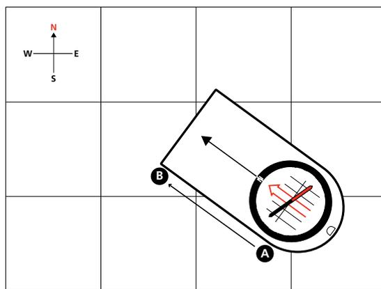
2. 旋转舱体，直到方向线与地图上的子午线平行且 N 指向北方。
